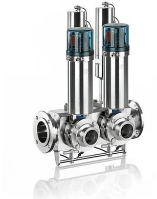
Die Doppelstoppstation blockiert den Molch in beide Richtungen, somit können beide Seiten der Molchleitung benutzt werden. Die Rückseite wird benutzt um das Produkt umzuleiten während auf der Vorderseite ein anderes Produkt eingespeist werden kann.
