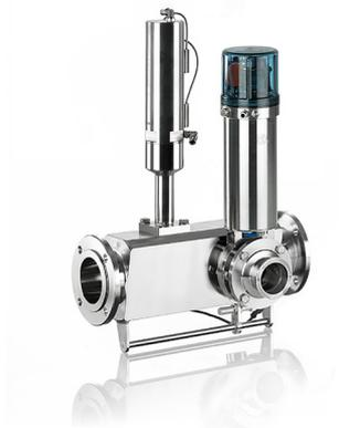
Dient zum Stoppen von Molchen und hat die Funktion einer Weiche. Der Molch wird in der Stoppstation blockiert und auf der Rückseite wird das Produkt in einen Behälter oder in eine andere Leitung umgeleitet.
